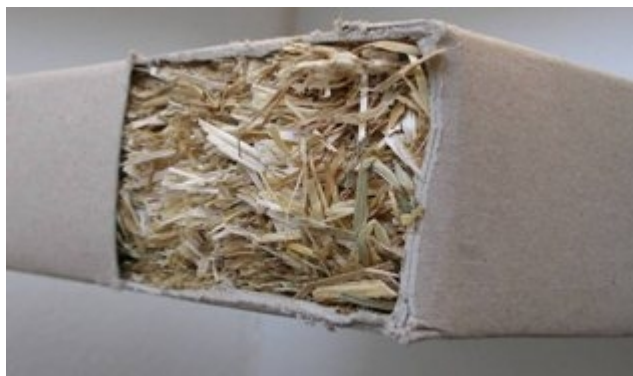
Obr. 1: Vzhled vnitřku panelu ze slaměných vláken tuzemské produkce.
